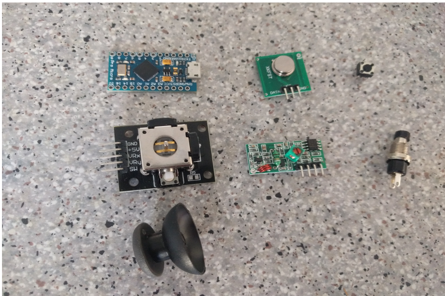
Kuva 1. Hyödynnettävät komponentit: Arduino Pro Micro ATmega32U4 5V/16MHz, Joystick ohjain arduinolle tatti irroitettuna, 433MHz RF lähetin ja vastaanotin, sekä kaksi erilaista painonappia.
